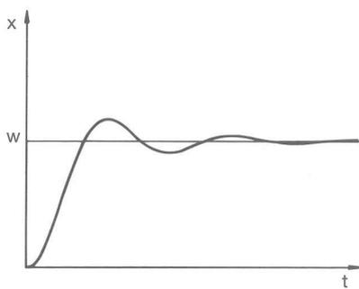
Abb. 68: Regelparameter  $T_n$  und  $T_v$  zu klein
